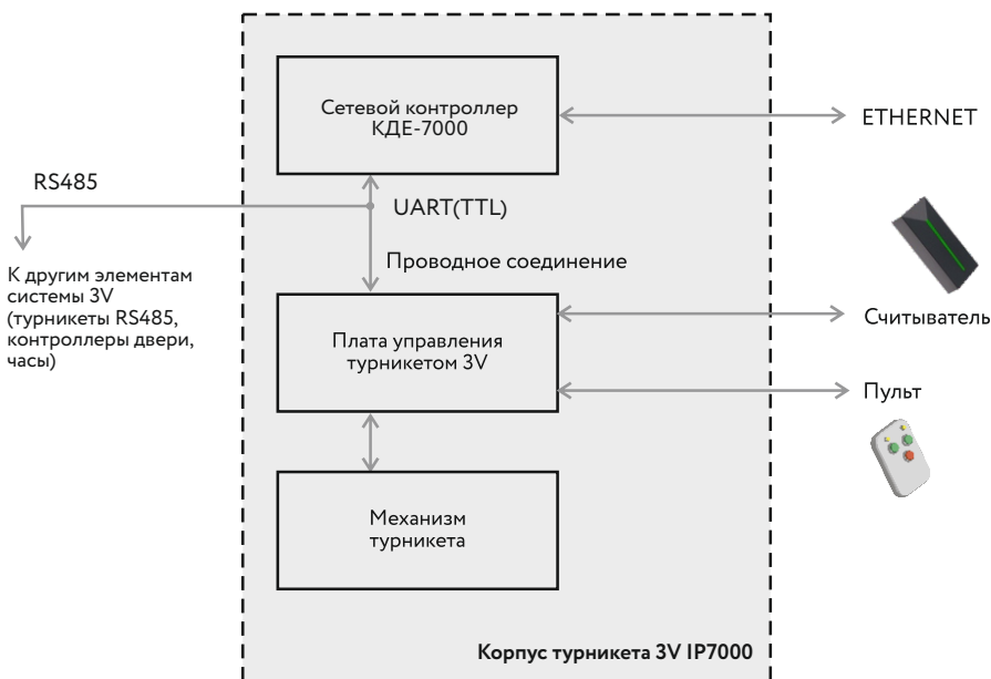
Рисунок 2.3 – Структура турникета IP7000
