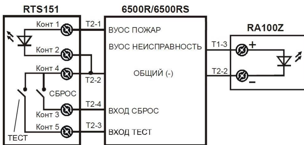
Рис. 4б Схема подключения пульта RTS151 с RA100Z
