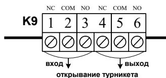
Пример 5. Подключение турникета (турникетный режим)
