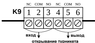
Пример 5. Подключение турникета (турникетный режим)
