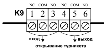
Пример 5. Подключение турникета (турникетный режим)
