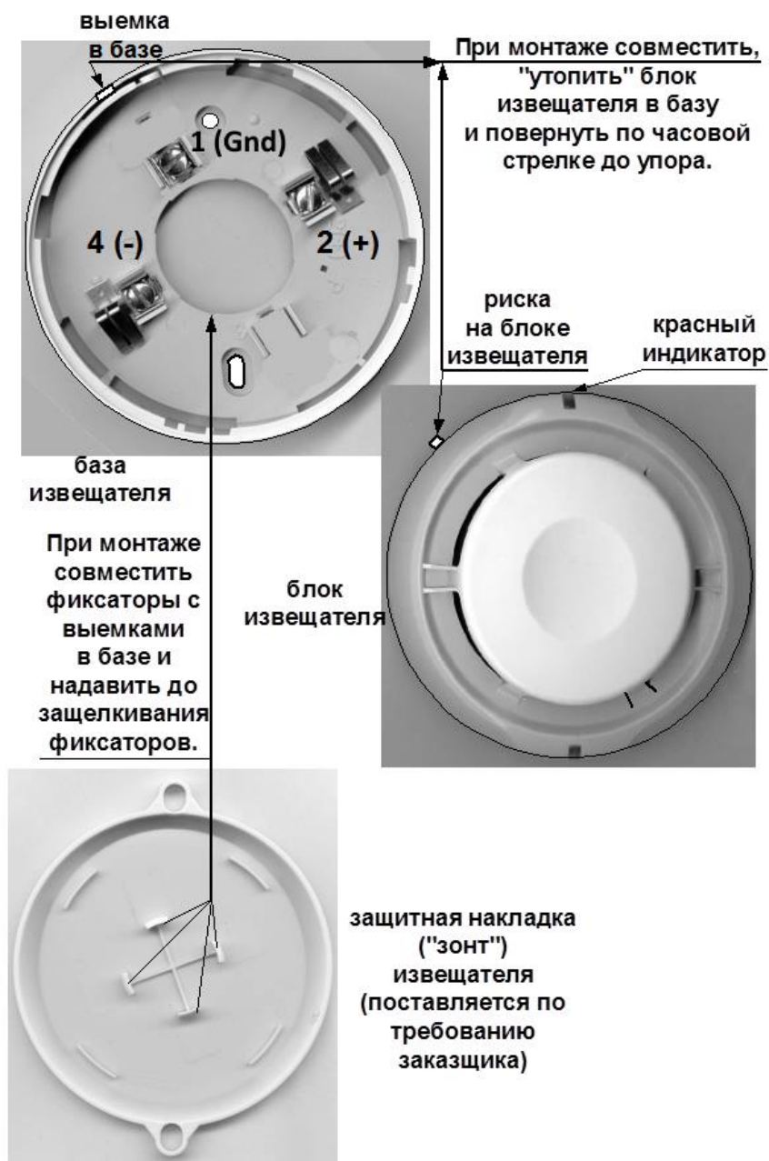
Рис. 2 А2ДПИ исп.09 (база, блок извещателя, «зонт»)
