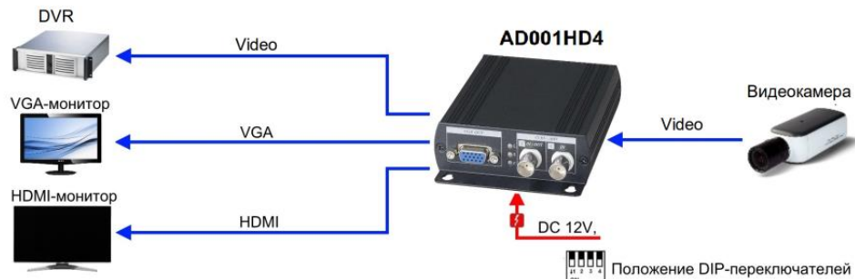
Рис.3 Схема подключения AD001HD4. Режим вывода сигналов HDMI, VGA и сквозной канал вывода изображения
