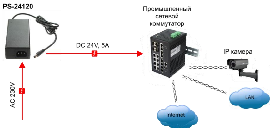
Рис.3 Типовая схема подключения блока питания PS-24120
