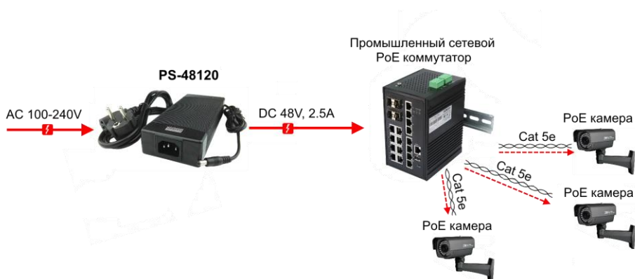
Рис.3 Типовая схема подключения блоков питания на примере PS-48120
