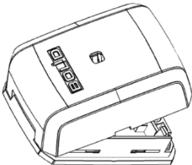
Рисунок 2.2.3 Установка крышки AP2
