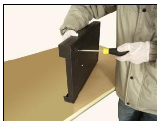
4.закрутите винты HDD
