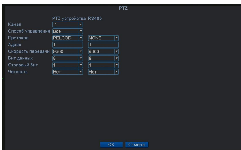
Рисунок 4.36 Конфигурация PTZ и RS485 устройств в аналоговом и гибридном режимах.
