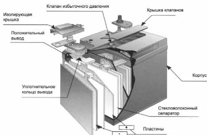
Рис. 1. Основные элементы конструкции аккумулятора технологии AGM с клапаном избыточного давления.
