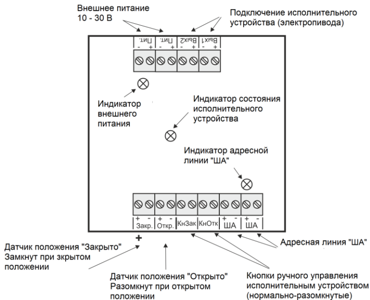
Рис. 2а. Расположение и назначение контактов модуля исполнений AMK-DC-IP30, AMK-DC-IP54
