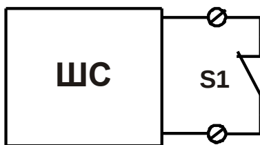
Рис. 8 Подключение НЗ контактов без контроля целостности линии связи.
