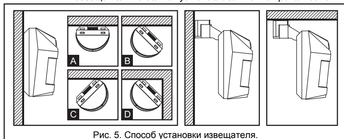
Рис. 5. Способ установки извещателя.
