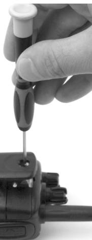
Рис. 6. Присоединение клипсы для крепления.
