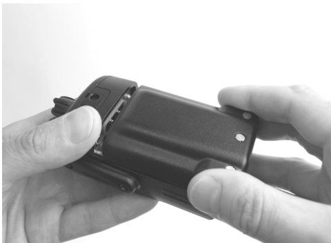
Рис. 3. Установка аккумуляторной батареи.
