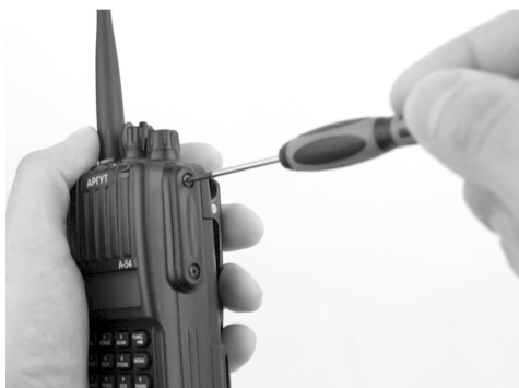
Рис. 10. Снятие заглушки аксессуарного соединителя.
