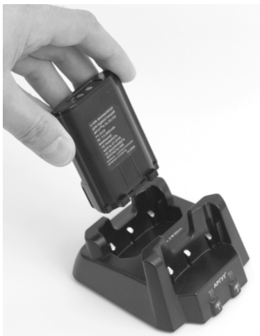
Рис. 9. Установка аккумуляторной батареи в слот 2 зарядной базы.
