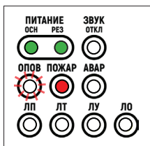
Рис. 44. Индикация при отсчете времени задержки воспроизведения речевого сообщения
