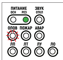
Рис. 29. Индикация в режиме удаления сообщения (на примере удаления тревожного сообщения)
