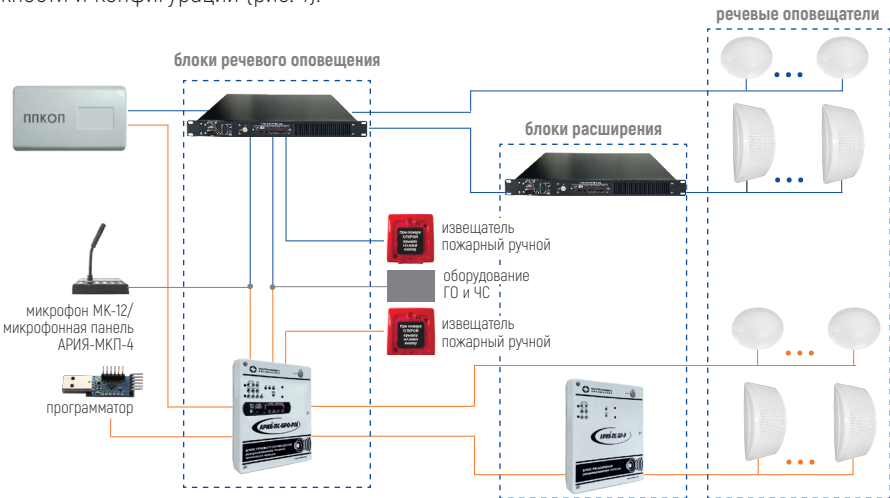
Рис. 1. Пример соединения оборудования в системе АРИЯ
