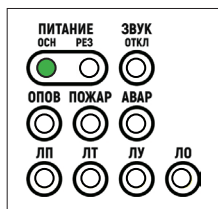
Рис. 25. Индикация при установке переключки в режим записи речевых сообщений
