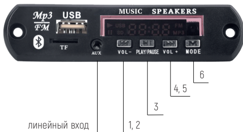
Рис. 46. Плеер, встроенный в корпус блоков АРИЯ-ПС-БРО-М, АРИЯ-ПС-БРО-РМ)
