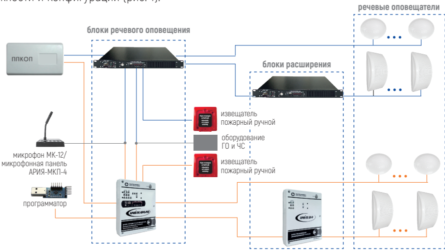
Рис. 1. Пример соединения оборудования в системе АРИЯ
