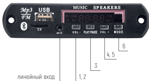
Рис. 46. Плеер, встроенный в корпус блоков АРИЯ-ПС-БРО-М, АРИЯ-ПС-БРО-РМ)
