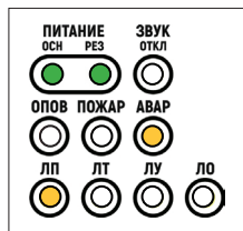
Рис. 52. Индикация при обрыве, коротком замыкании или установке резисторов несоответствующего номинала между изделием и ППК
