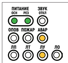
Рис. 56. Индикация при обрыве, коротком замыкании или установке оконечного резистора Rok BP несоответствующего номинала в линии управления
