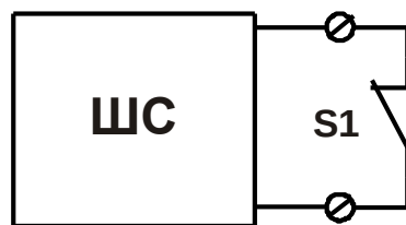
Рис. 6 Подключение извещателя с НЗ контактами без контроля целостности линии связи
