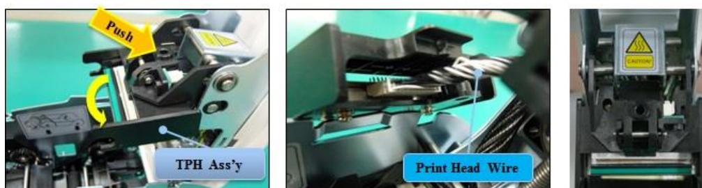
Рис. 96 Замена Печатной головки
