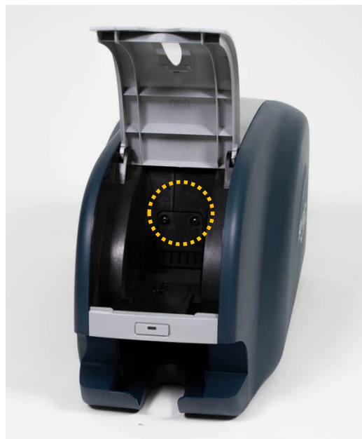
Рис. 16 Модуль настройки толщины карт
