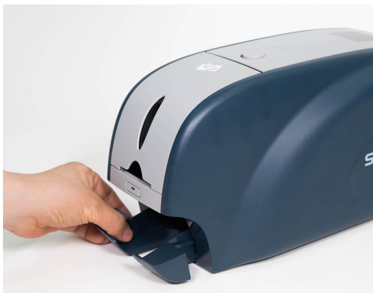
Рис. 24 ADVENT SOLID-310 «Разделение» лотка выдачи карт
