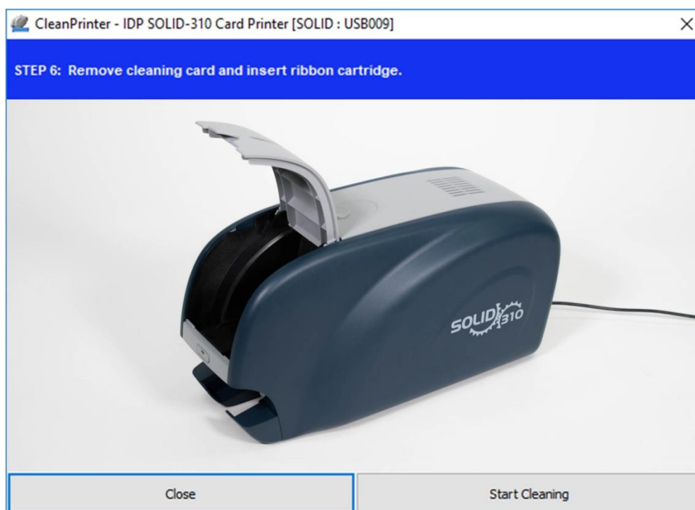
Рис. 93 Очистка Принтера Шаг 6
