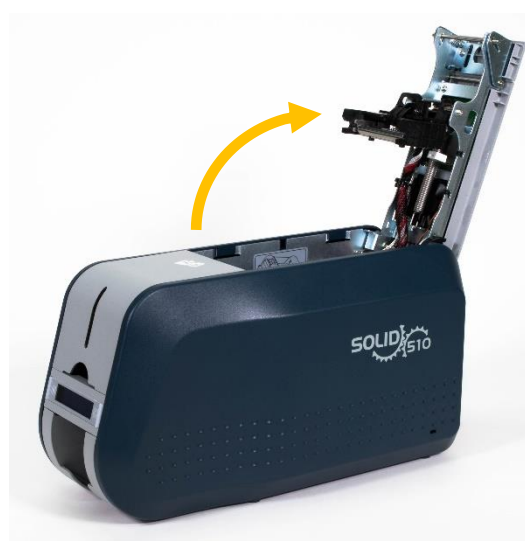
Рис. 13 Открытие крышки принтера
