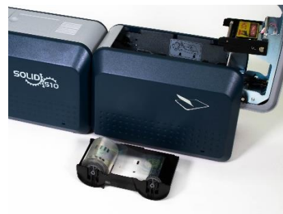
Рис. 22 Установка пленки ламинатора
