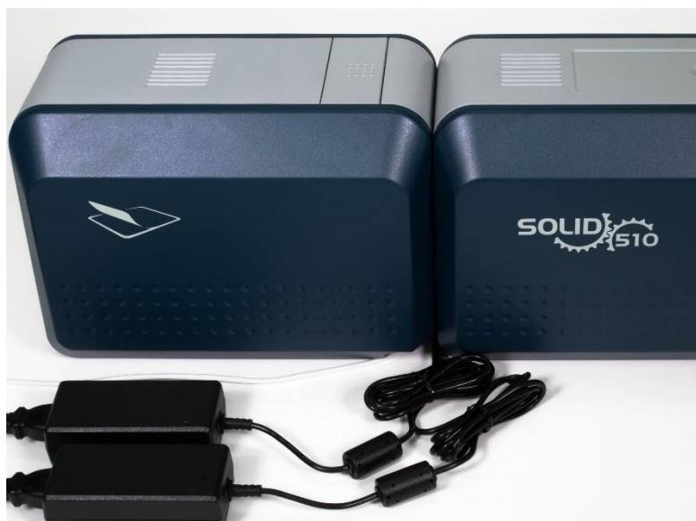
Рис. 12 SOLID-510L Коннект обоих кабелей питания и USB-провода
