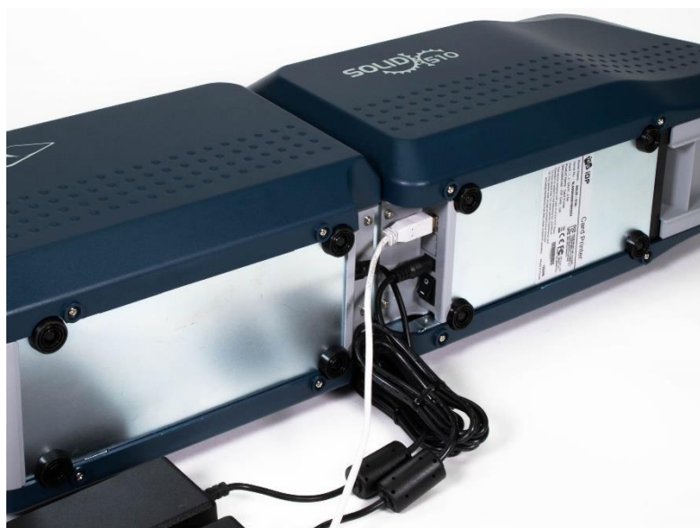
Рис. 11 SOLID-510L Коннект обоих кабелей питания и USB-провода
