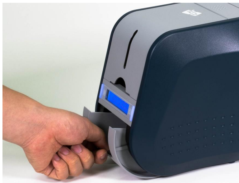
Рис. 32 SOLID-510 Изъятие лотка и разведение в стороны
