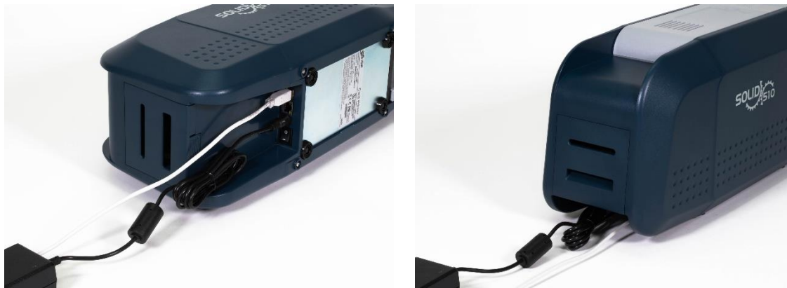
Рис. 10 SOLID-510D Коннект кабеля питания и USB кабеля
