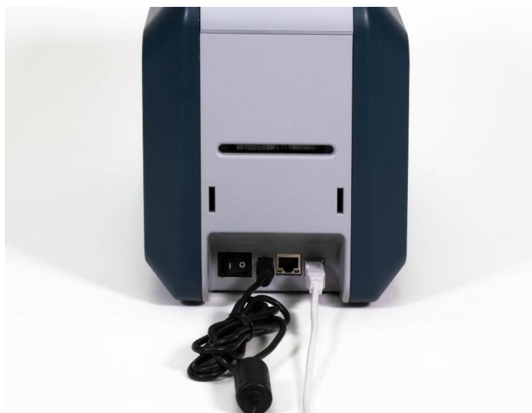
Рис. 9 SOLID-510S Коннект кабеля питания и USB кабеля
