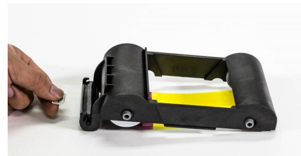
Рис. 18 Удаление защитной ленты
