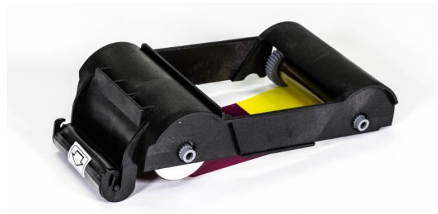
Рис. 17 Установите чистящий ролик
