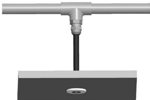
Рисунок 5. КАПИЛЛЯРНАЯ ТРУБКА С ВОЗДУХОЗАБОРНЫМ ОТВЕРСТИЕМ
