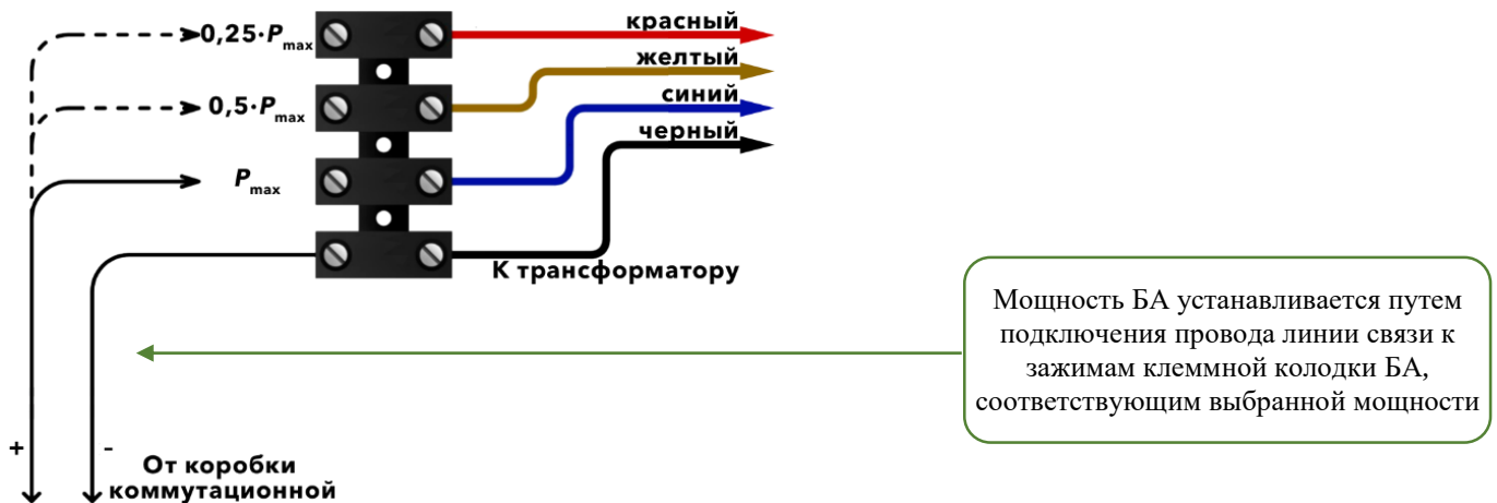
Рисунок 2. Схема подключения и установки мощности БА АСР-01.1.8 исп. XX.АА с полиэтиленовой клеммной колодкой, с возможностью контроля по переменному току (импедансу).
