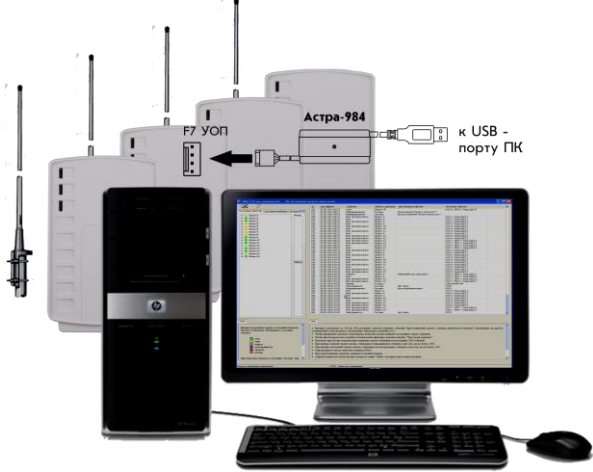
Рисунок 4. Подключение УОП к ПК.
