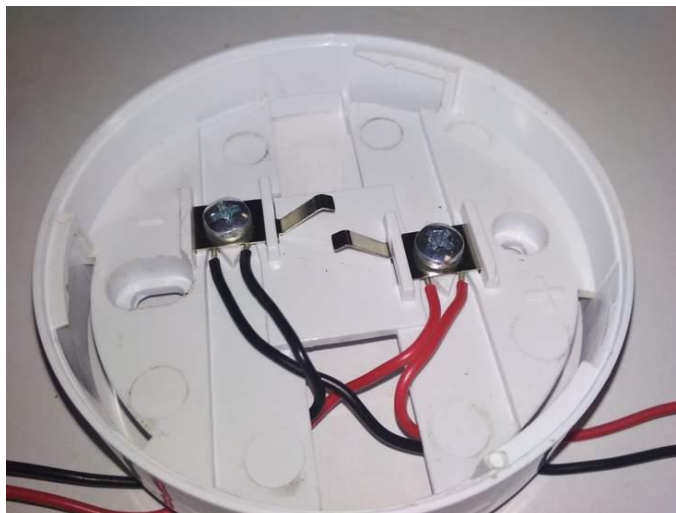
Рис. 6 Присоединение проводов к базе
