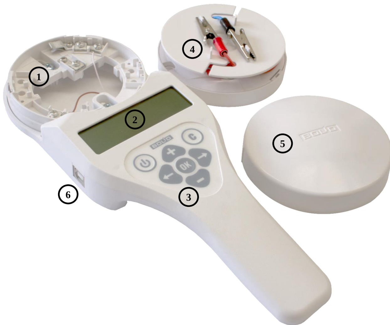
Рисунок 1. Внешний вид и органы управления программатора.
