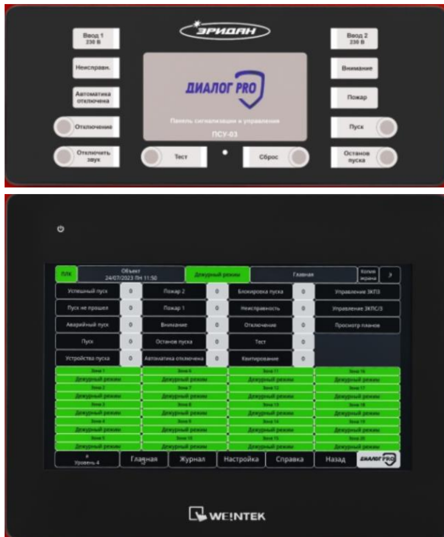
Рисунок 1.1 – Внешний вид панели оператора
