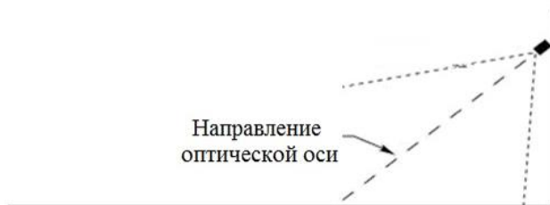
Рисунок 4 – Рекомендуемая установка термокожуха по отношению к горизонту
