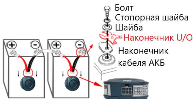
Рис. 1.5.1 – Подключение датчиков АКБ к батареям
