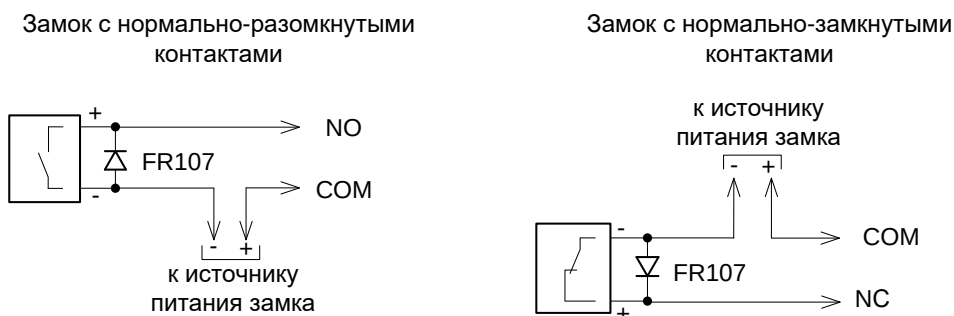
Рисунок 4. Схемы подключения контроллера
