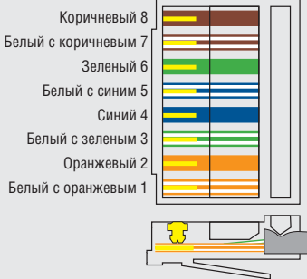
Рисунок 6. Обжимка кабеля UTP
