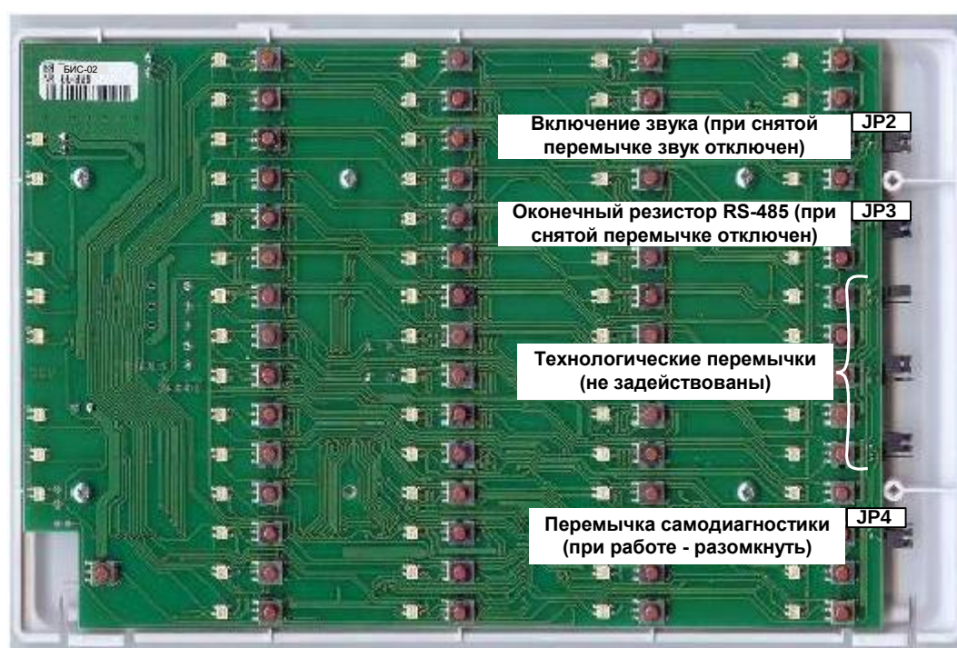
Рис. 4 Перемычки (вид со снятой передней крышкой, спереди).
