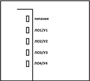
Рисунок – 3 Схема подключения оповещателей по варианту №2 (п. 3.3.1 настоящего руководства по эксплуатации).
