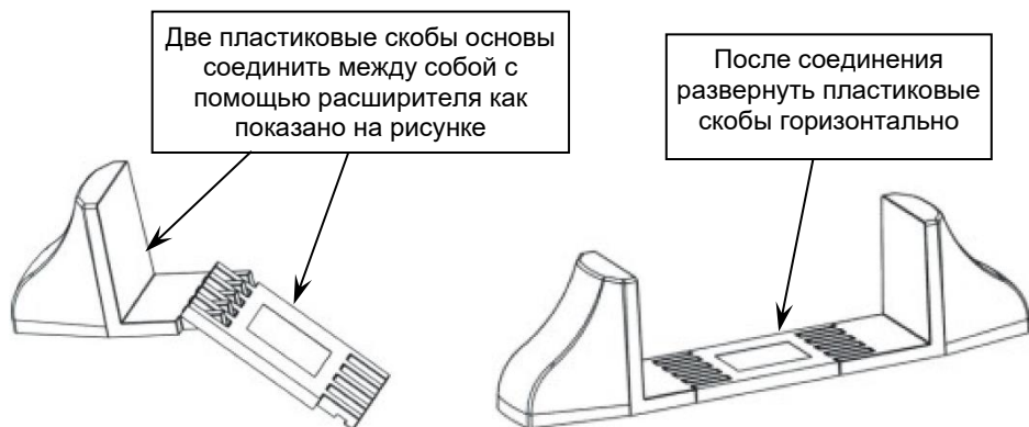
Рисунок 3 – Сборка пластиковых основ и расширителя для вертикальной установки ББ с ИБП
