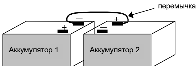
Рисунок 2 – Схема последовательного соединения двух аккумуляторов
