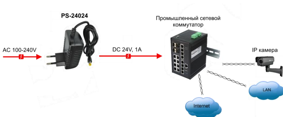
Рис.3 Типовая схема подключения блоков питания на примере PS-24024
