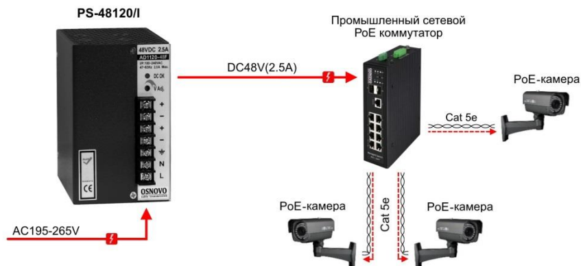
Рис.4 Типовая схема подключения блоков питания на примере PS-48120/I
