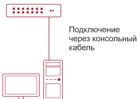
Рисунок 4-3. Подключение ПК к консольному порту коммутатора
