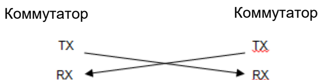
Рисунок 7-3. Подключение оптического кабеля
