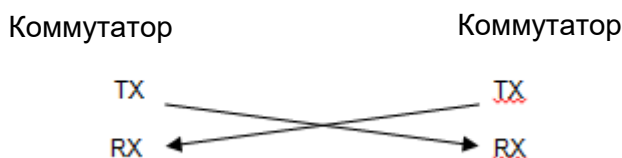
Рисунок 7-3. Подключение оптического кабеля
