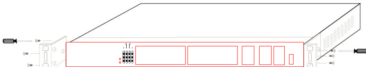
Рисунок 3-1 Монтаж кронштейнов на коммутатор
