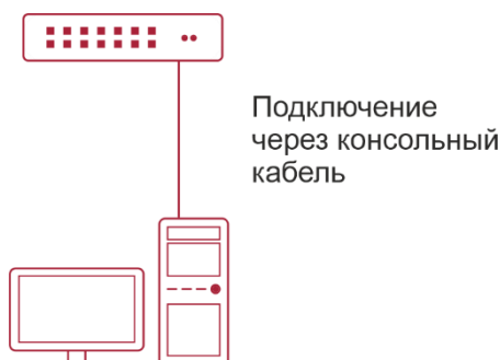
Рисунок 4-2. Подключение ПК к консольному порту коммутатора
