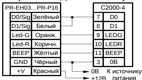
Рисунок 17. Схема подключения считывателей PR-EH03, PR-EH05, PR-EH09, PR-EH16 PR-P05, PR-P09, PR-P16.
