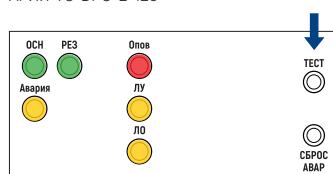
Рис. 32. Индикация режима «Тест» на двухзональном БРО
