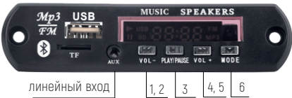
Рис. 25. Плеер, встроенный в блок речевого оповещения АРИЯ-ТСА-БРО
