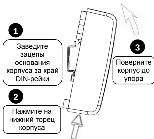
Рисунок 3. Крепление блока на DIN-рейку
