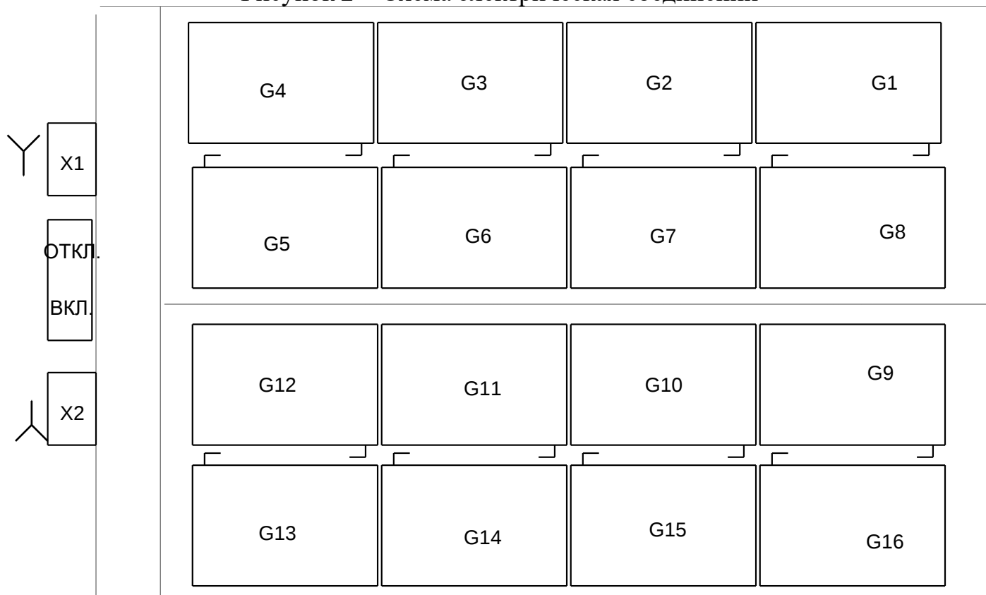
Рисунок 3 – Схема установки и соединений аккумуляторных батарей
