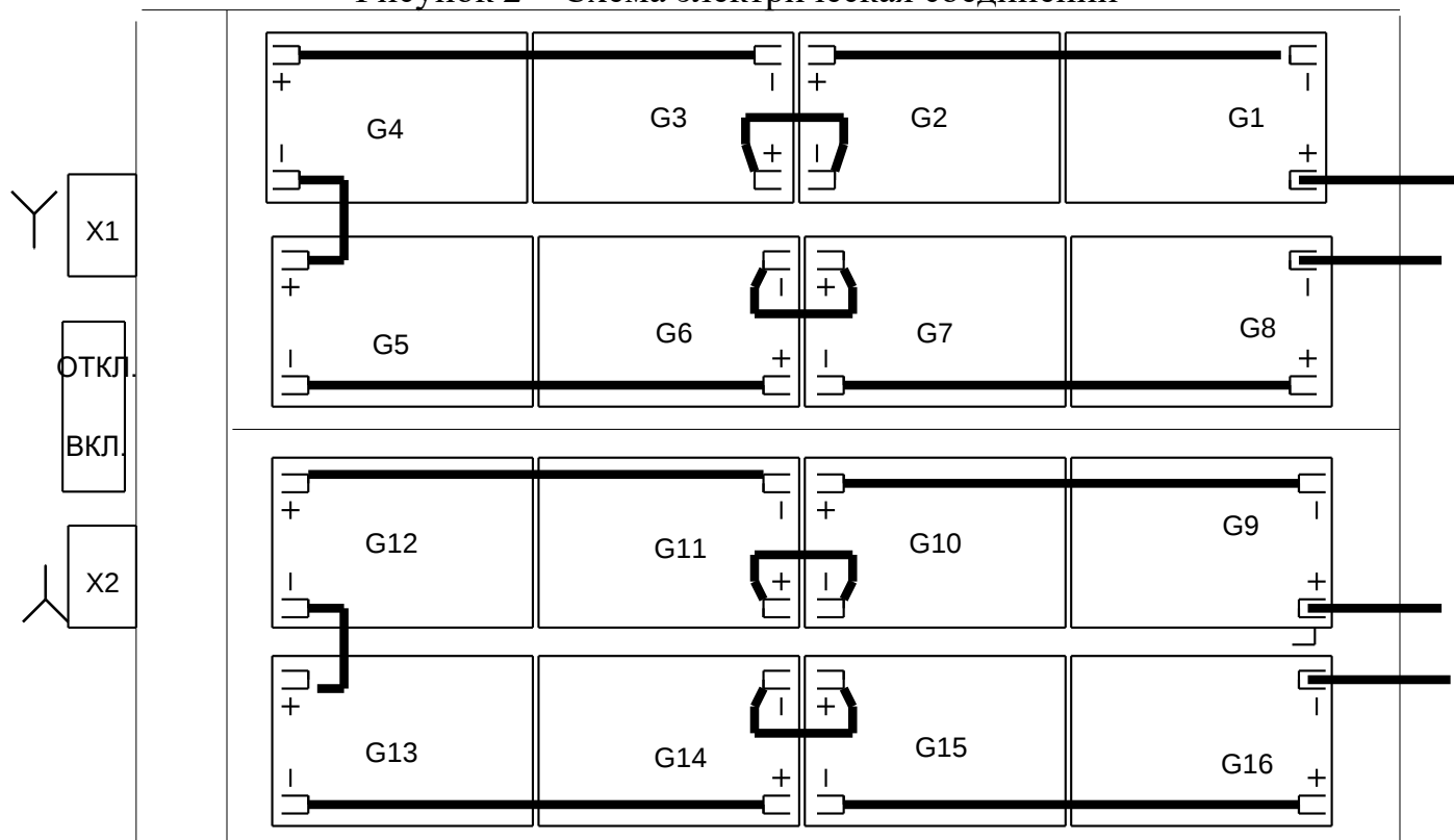
Рисунок 3 – Схема установки и соединений аккумуляторных батарей
