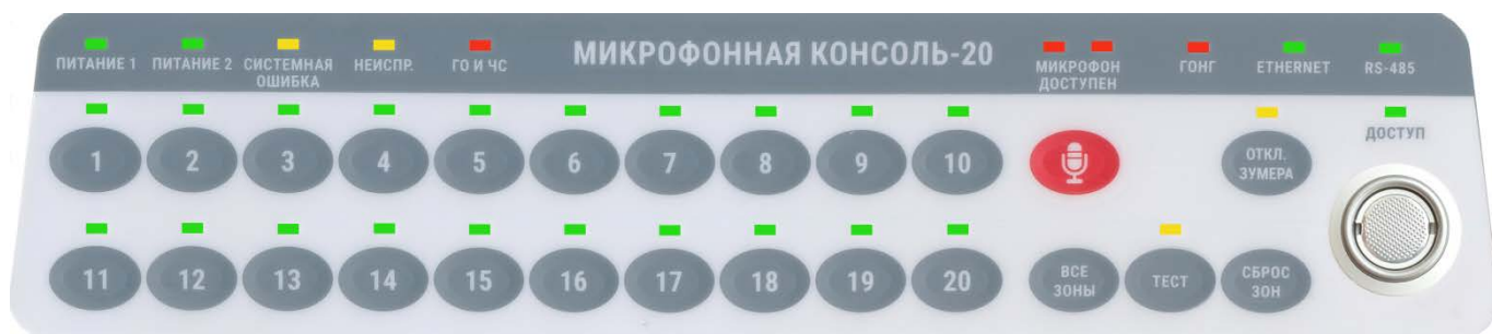
Рисунок 1.4.1. Внешний вид лицевой панели консоли.
